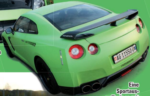
Eine Sportauspuffanlage mit Klappensteuerung sorgt für brachialen Sound.
