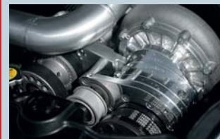
KRAFTSPENDER Der Novidem Kompressor ist per Knopfdruck bis 4500/min zuschaltbar.
