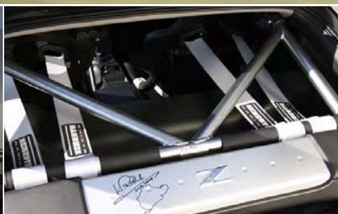
Mit Sicherheit: Sechspunkt-Gurte von Schroth und sicherheitsrelevanter Überrollbügel hinter den beiden Sitzen
