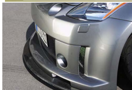
Extraportion: Die Öffnungen in der Front führen Motor und Bremse mehr Luft zu
