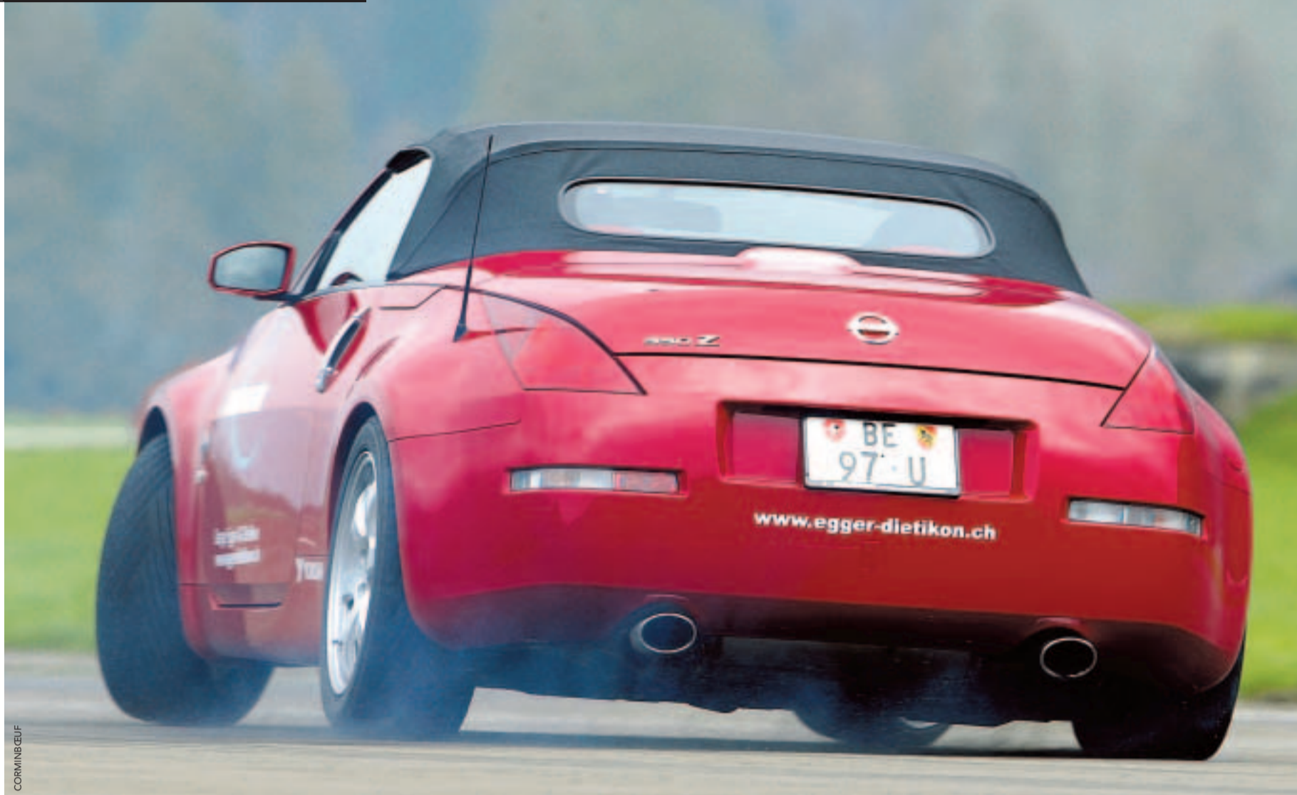
Mit zugeschaltetem Kompressor und somit 380 PS können bei ausgeschaltetem ESP erhebliche Traktionsprobleme auftreten. Die Bremsen sind der Mehrleistung gewachsen.
