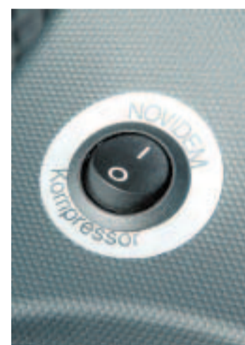
Die 100 Mehr-PS werden mittels Wippschalter aktiviert.
