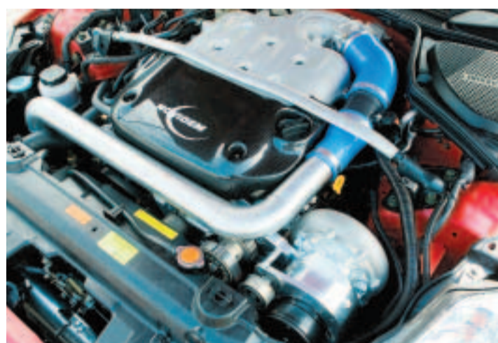
Der Kompressor (Radialverdichter, im Bild unten rechts) von Novidem ist akustisch präsent, aber nicht störend.
