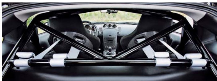
Der Überrollkäfig dient nicht nur der eigenen Sicherheit. Die mit dem Blech verschweißten Metallstreben sorgen auch für mehr Karosseriesteifigkeit
