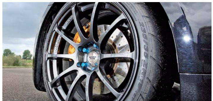
Hinter den direkt aus Japan importierten Advan-Racing-Rädern in 19 Zoll wohnt die Serienbremsanlage mit gelochten und geschlitzten Scheiben
